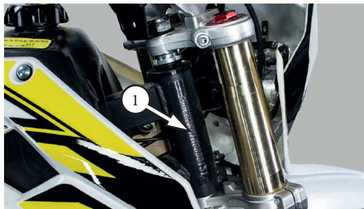
Фото 1.3. Место расположения серийного номера (VIN) – 1
