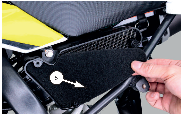
Фото 5.7. Обслуживание воздушного фильтра закрытого типа
