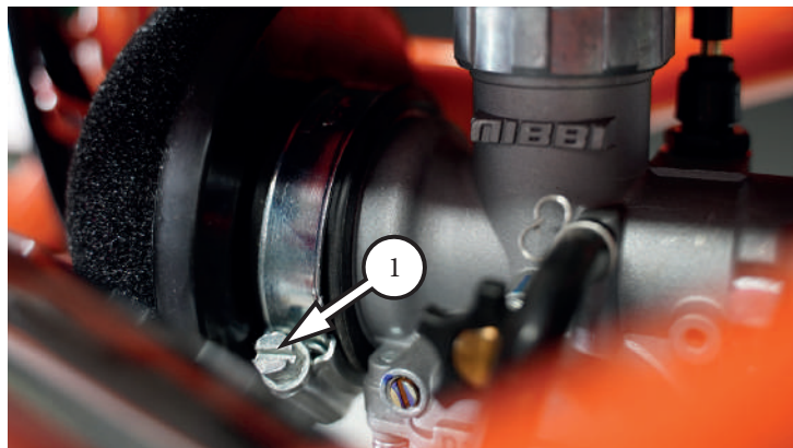
Фото 5.6. Крепление воздушного фильтра
