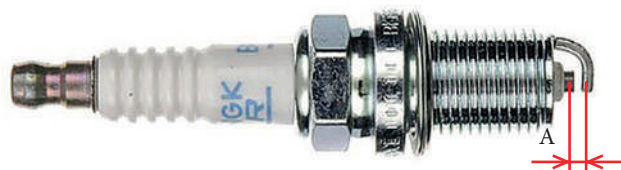
Фото 5.14. Зазор свечи зажигания – А
