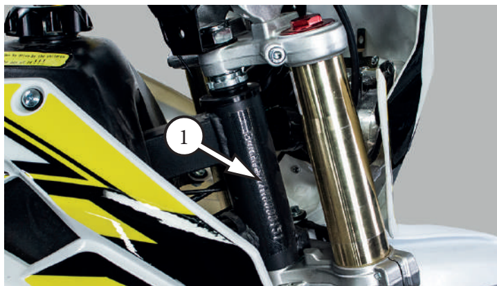
Фото 1.3. Место расположения серийного номера (VIN) – 1
