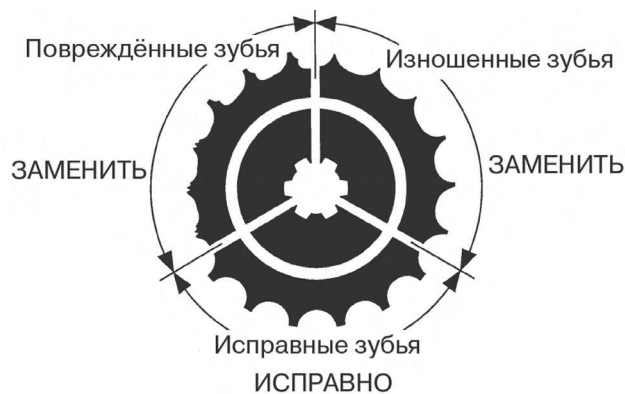
Рисунок 5.24. Вид зубьев звездочки
