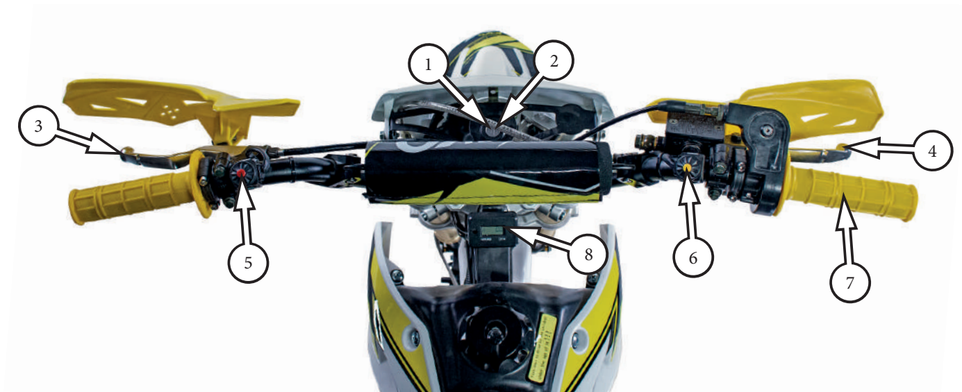
Фото 2.3 Приборы и органы управления: 1 – замок зажигания; 2 – вкл./выкл. фары (не на всех моделях); 3 – рычаг сцепления; 4 – рычаг переднего тормоза; 5 – кнопка выключения двигателя; 6 – кнопка стартера; 7 – рукоятка акселератора; 8 – приборная панель/счетчик моточасов
