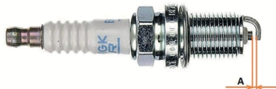
Фото 5.16. Зазор между электродами свечи зажигания
