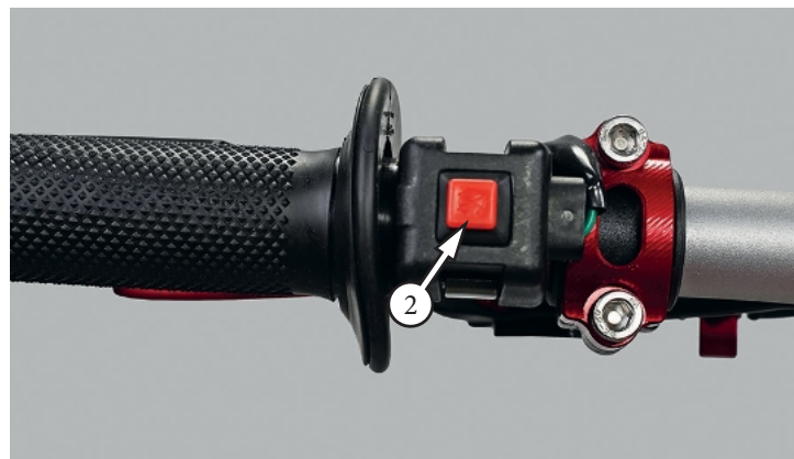
Фото 3.5.2. Кнопка остановки двигателя – 2
