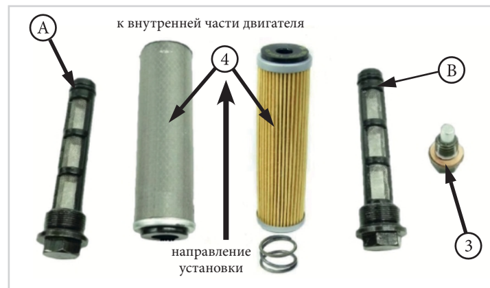
Фото 5.4.1. Замена масла в двигателях с масляным фильтром
