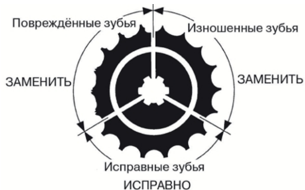
Рисунок 5.27. Вид зубьев звездочки
