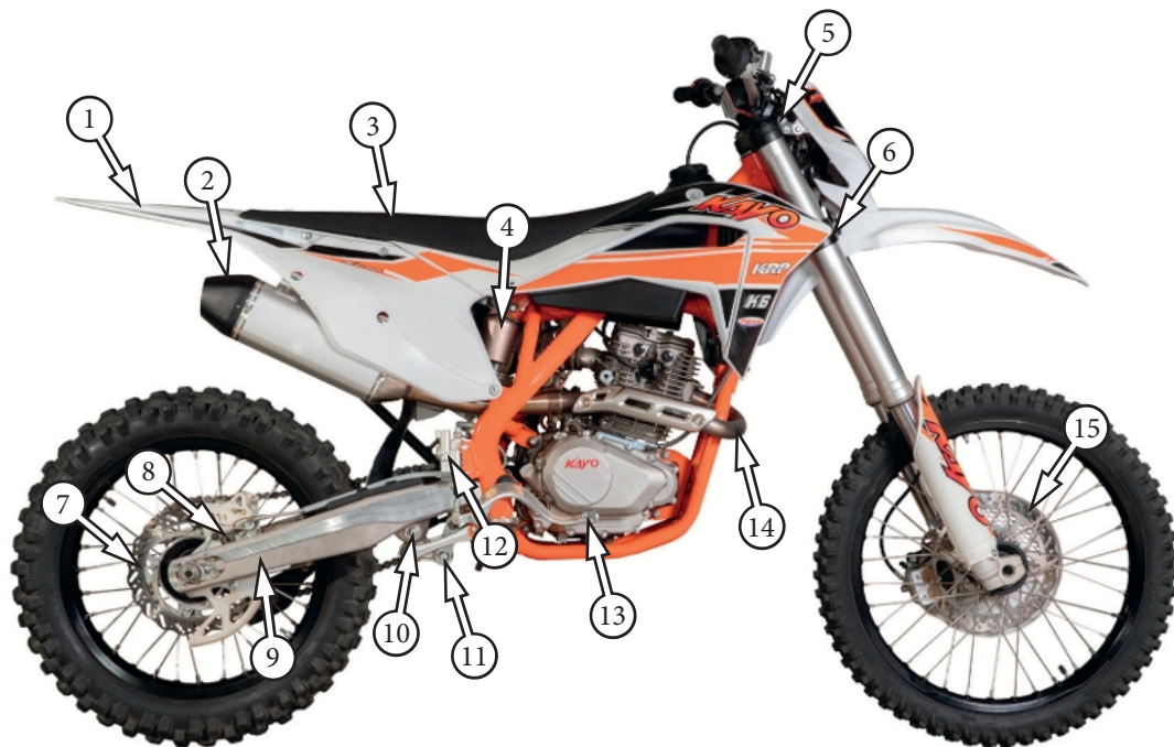
Фото 2.2. Правая сторона мотоцикла (вариант): 1 – заднее крыло; 2 – глушитель; 3 – сиденье; 4 – задний амортизатор; 5 – верхний зажим; 6 – нижний зажим; 7 – диск заднего тормоза; 8 – задний тормозной суппорт; 9 – маятник; 10 - треугольное коромысло; 11 – U-образное коромысло; 12 – задний тормозной цилиндр; 13 – педаль заднего тормоза; 14 – выхлопная труба; 15 – диск переднего тормоза
