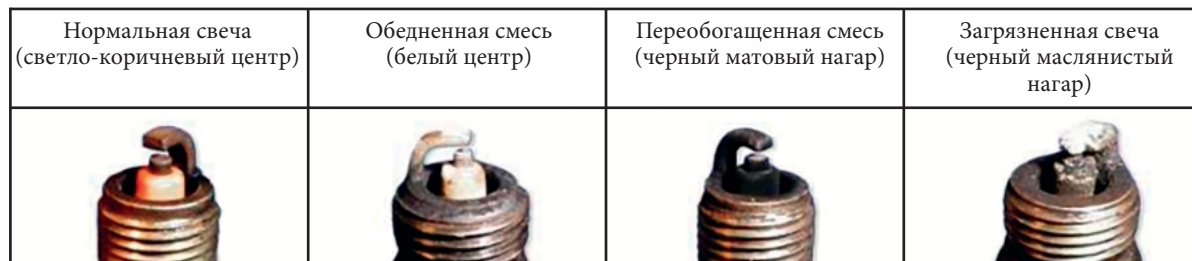
Фото 5.15. Состояния свечей зажигания
