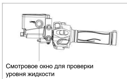
Рис. 26 Проверка уровня тормозной жидкости переднего тормоза
