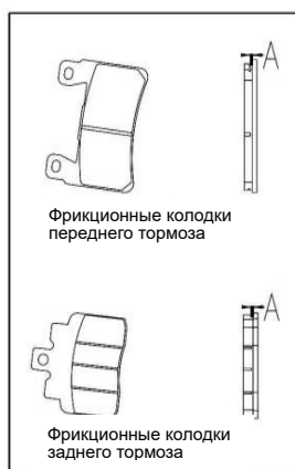
Рис. 25 Проверка фрикционной накладки переднего тормоза
