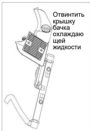
Рис. 33 Долив охлаждающей жидкости
