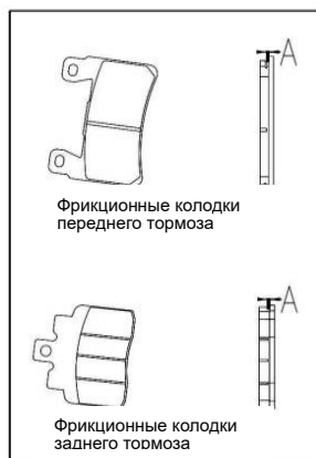
Рис. 29 Проверка фрикционной накладки заднего тормоза
