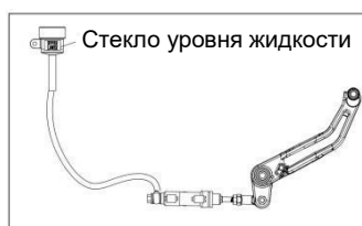
Рис. 30 Проверка уровня тормозной жидкости в системе заднего тормоза
