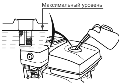
Рис. 20 Максимальный уровень топлива в топливном баке
