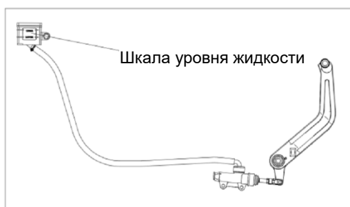
Рис. 37 Проверка уровня тормозной жидкости заднего тормоза
