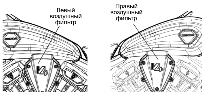
Рис. 25 Расположение воздушных фильтров
