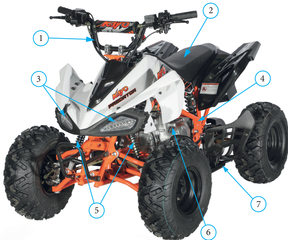
Фото 2.1. Левая сторона комплекта запчастей: 1 – руль с органами управления; 2 – сиденье; 3 – передние фары; 4 – рама; 5 – передняя подвеска; 6 – двигатель; 7 – левая подножка водителя
