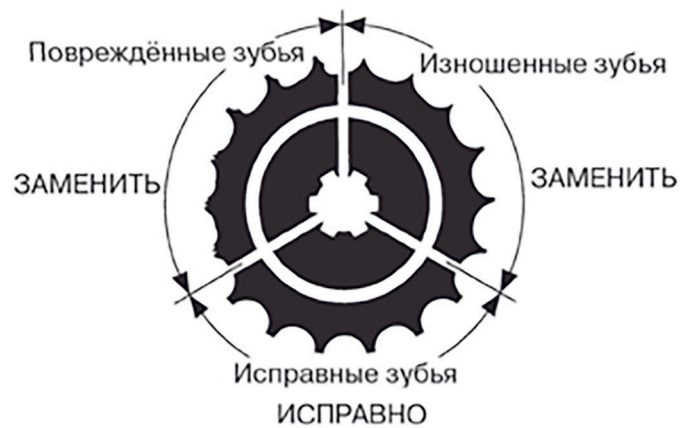
Рисунок 5.14. Вид зубьев звездочки
