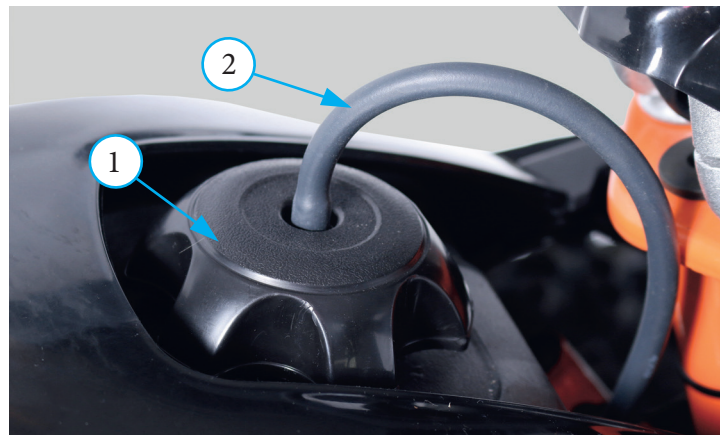
Фото 5.1. Крышка топливного бака - 1; трубка сапуна - 2
