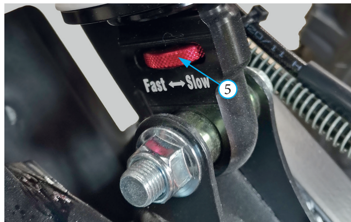
Фото 5.22. Гайка регулировки отбоя заднего амортизатора
