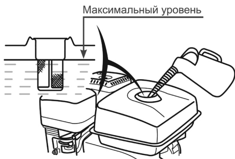
Рис. 5 Максимальный уровень топлива в топливном баке
