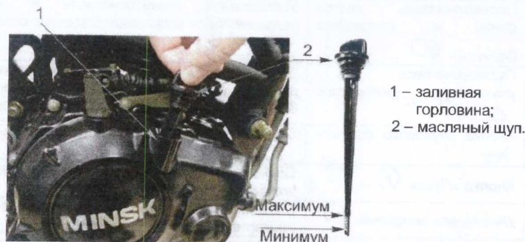
Рисунок 6 – Проверка уровня масла в двигателе
